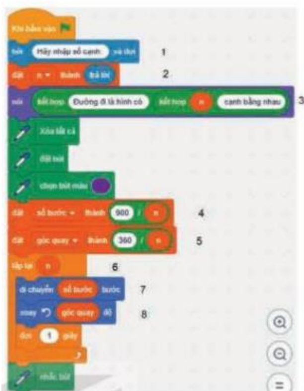
Hình 13.4. Chương trình điều khiển nhân vật di chuyển theo hình có số cạnh được nhập vào từ bàn phím
