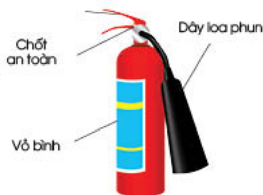
Cấu tạo bình chữa cháy khí \text{CO}_2
