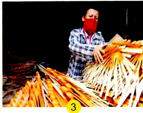
Bước 2: Chẻ ống tre, vót nhọn, đóng đinh tạo thành nan quạt
