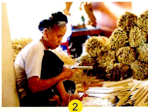
Bước 2: Chẻ ống tre, vót nhọn, đóng đinh tạo thành nan quạt
